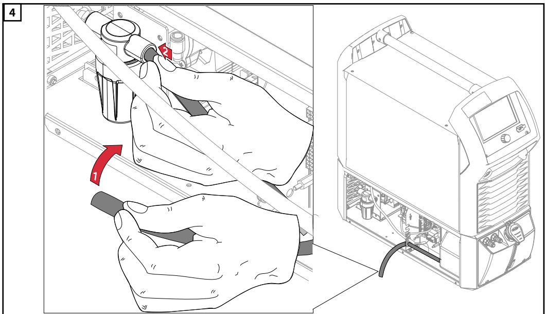
冷却液ホースを冷却液プレフィルターに差し込みます
